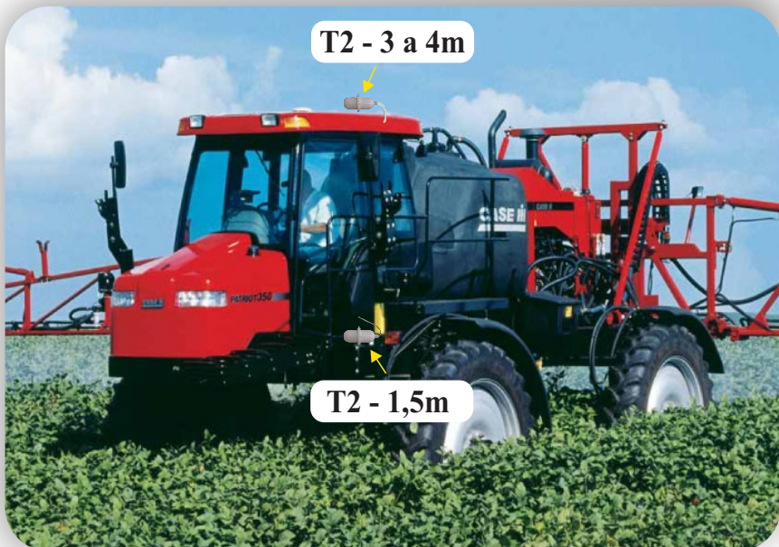
Foto 5 – Sensor de Inversão Térmica instalado em autopropelido Patriot.
